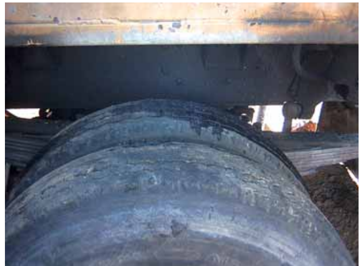
► N° 4: Vista "fuga" de aceite sobre rueda camión.
