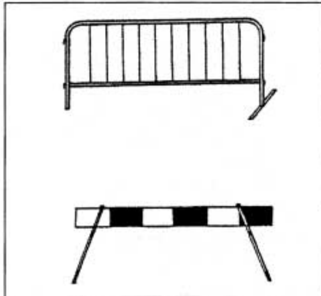
Vallado de Señalización
